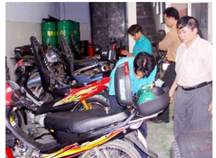
GS. Bùi Văn Ga đang hướng dẫn lắp bộ chuyển đổi nhiên liệu cho xe máy
