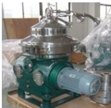
Máy ly tâm bướm, được sử dụng để ly tâm sản phẩm dầu dừa. Nguồn: Công ty Công nghệ QQC.
