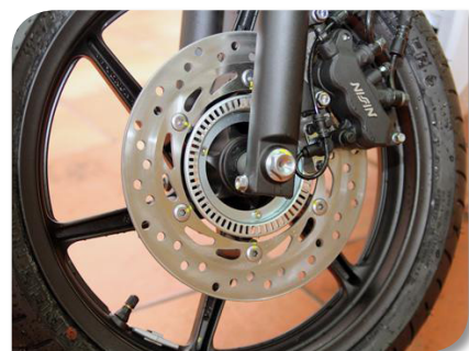
Phanh ABS trên bánh xe Honda SH300i Sporty ABS 2012. Nguồn: Trang thông tin điện tử Báo Khánh Hòa
