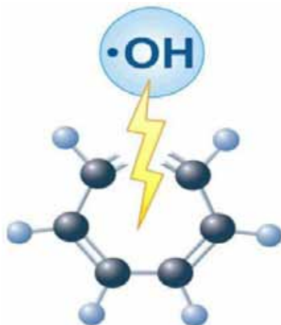
Gốc OH- phản ứng phá hủy các chất ô nhiễm hữu cơ trong nước.
