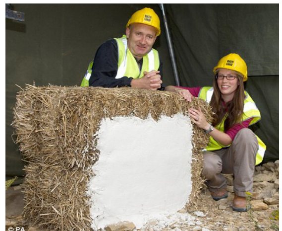
Giáo sư Pete Walker và đồng sự đang thử nghiệm một kiện rơm trát vữa.
