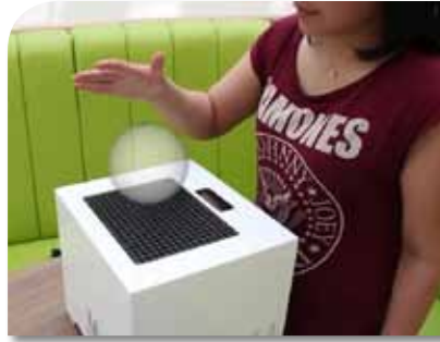
Công nghệ haptic của Đại học Bristol: dùng sóng siêu âm tạo vật thể 3 chiều có thể nhìn và cảm nhận được.
