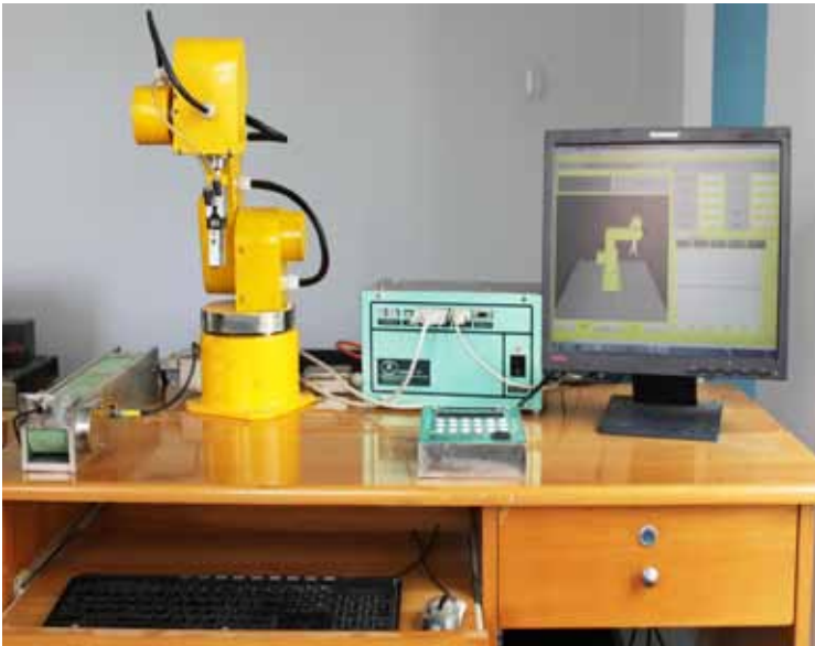
Robot 5 bậc tự do cho đào tạo AKBOT-1 và VNR-T1.
