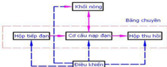
Hình 6. Nguyên lý hoạt động của hệ thống bắn pháo hoa tự động nạp đạn.
