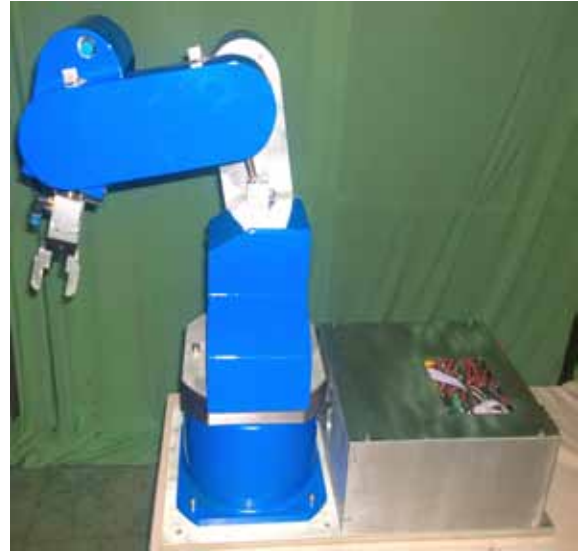
Robot 5 bậc tự do cho đào tạo AKBOT-1 và VNR-T1.
