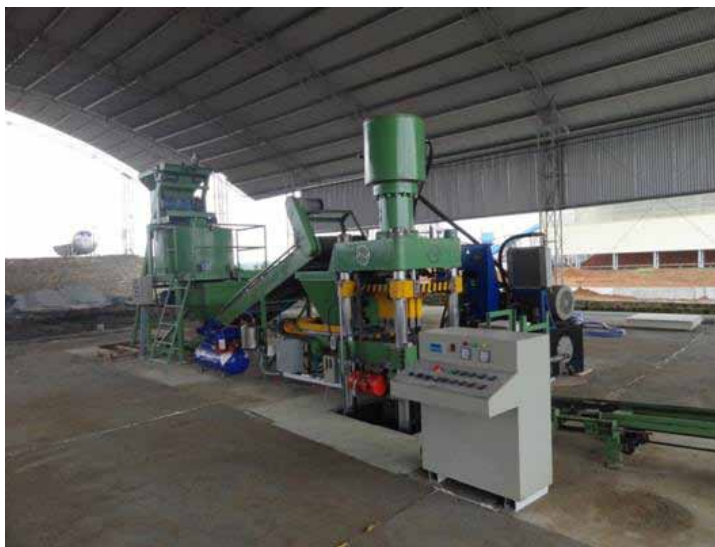
Dây chuyền gạch không nung Trung Hậu đã lắp đặt tại Công ty Thiên Việt (Lâm Đồng)
