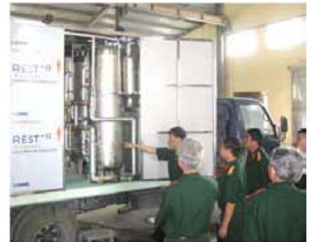
Hệ thống lọc nước cơ động do Viện Công nghệ Môi trường nghiên cứu, chế tạo, vận hành ngay trên xe tải, giúp đi khắp mọi nơi.
