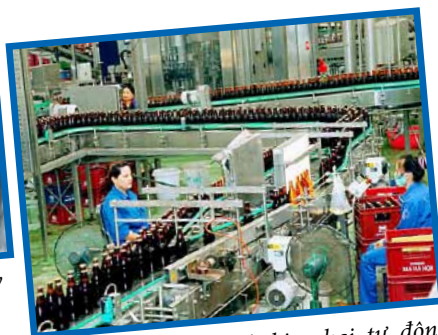
Dây chuyền sản xuất bia chai tự động hoàn toàn ở Công ty Cổ phần Bia Hà Nội - Hải Dương.
