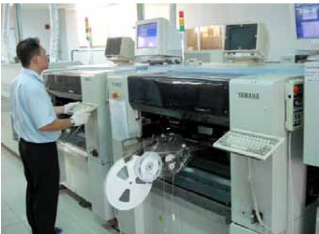
Dây chuyền sản xuất bóng đèn compact sử dụng công nghệ SMT tại Công ty Cổ phần Bóng đèn Điện Quang.
