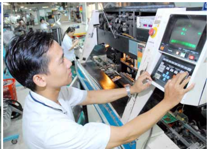
Sản xuất linh kiện điện tử xuất khẩu sang Nhật Bản, châu Âu... trên dây chuyền SMT tại Công ty Cổ phần điện tử Bình Hòa.
