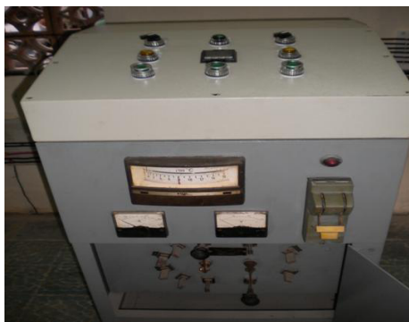
Thiết bị khống chế tốc độ gia nhiệt và biến thể nhiều nấc. Ảnh: B.V
