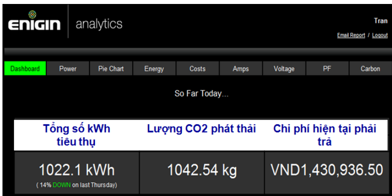
Bảng hiển thị chính trên hệ thống giúp doanh nghiệp tìm thấy những thông tin: số kW tiêu hao, chi phí điện năng, lượng CO 2 thải ra
