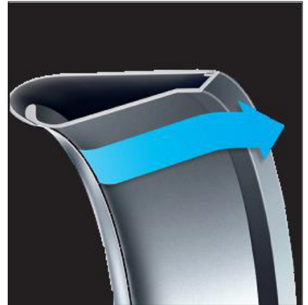
3. Tiếp theo nó đi qua một mặt cong của vành khuyên có biên dạng cánh khí động với góc nghiêng 16° để điều chỉnh hướng dòng.
