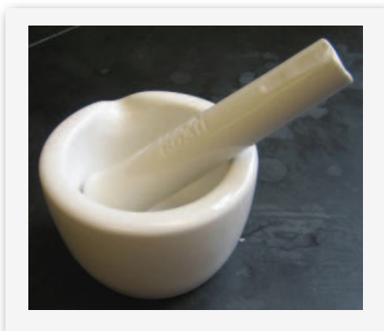
Cối và chày bằng alumina dùng trong phòng thí nghiệm
