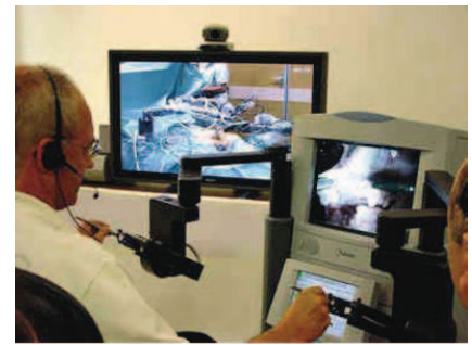
Một ca phẫu thuật hoàn toàn do robot đảm trách được các bác sĩ điều khiển từ xa thông qua kết nối viễn thông.
