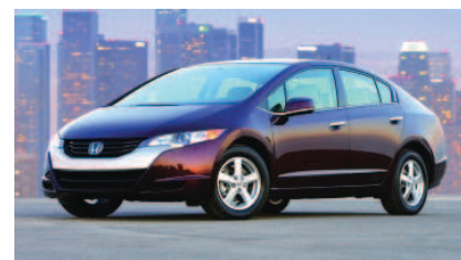
Xe Honda FCX dùng pin nhiên liệu hydro
